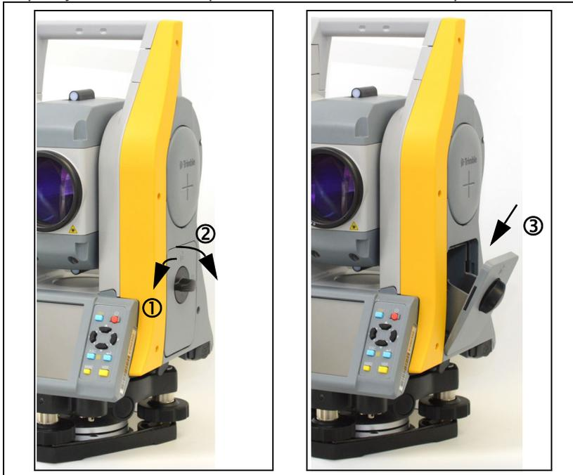
1. Поверните ручку фиксатора батарейного отсека против часовой стрелки и откройте крышку батарейного отсека.
