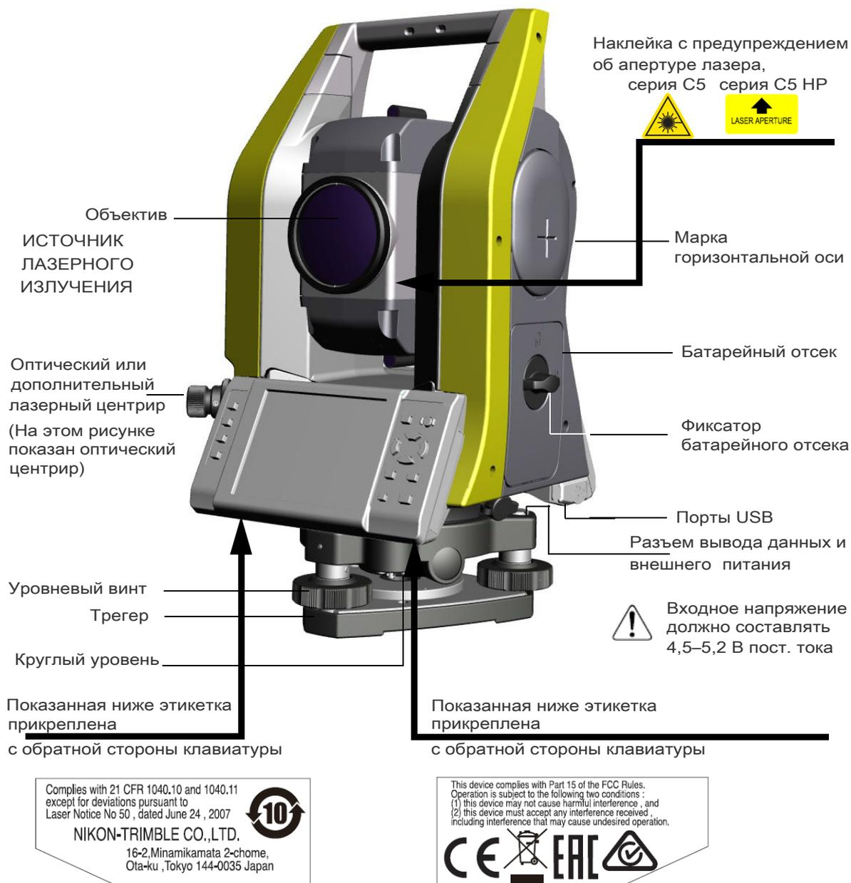
На данном рисунке показана модель, оснащенная оптическим центриром. Серия тахеометров Trimble включает как модели с лазерным центриром, так и модели с оптическим центриром.
