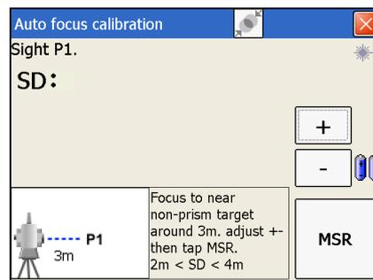
2. После измерения расположенной вблизи цели наведите инструмент на безотражательную цель на расстоянии не менее 100 м и выполните указанную выше процедуру фокусировки: сначала используйте фокусирующее кольцо, а затем нажимайте кнопки «+» и «-» для точной настройки. Затем выполните измерение расстояния, нажав кнопку «ИЗМ».
