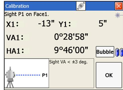
При наведении инструмента на цель, у которой значение VA превышает 3°, отобразится предупреждение, и кнопка «ОК» будет отключена.
