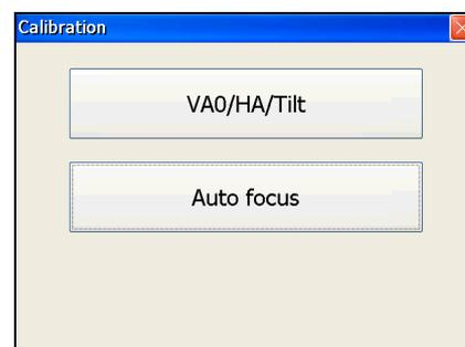
1. Наведите инструмент на безотражательную цель на расстоянии 2–4 м и выполните фокусировку вручную с помощью фокусирующего кольца. Затем с помощью кнопок «+» и «-» точно настройте фокусировку. После выполнения точной настройки нажмите кнопку «ИЗМ».
