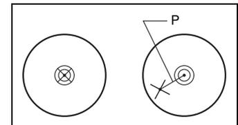
**Примечание.** Для юстировки лазерного центрира снимите колпачок.
