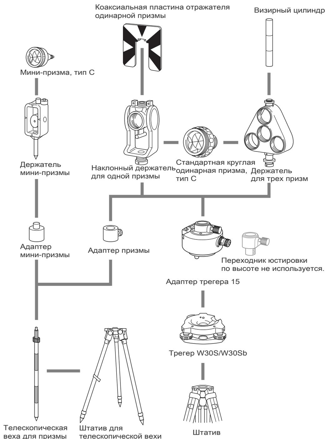
Рисунок 5.2 Компоненты призмного отражателя
