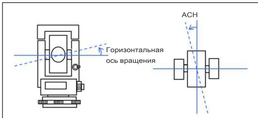
Поскольку значение компенсации изменяется в соответствии с вертикальным углом, при включении компенсации возникает небольшое перемещение по горизонтальному углу, даже при фиксации винта наводки.
