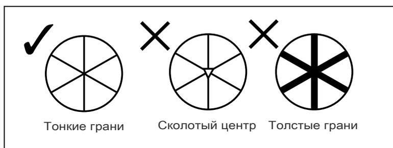
Поскольку тахеометры Trimble C5 являются чрезвычайно чувствительным инструментами, при наличии нескольких отражений на поверхности призмы точность измерения может значительно снизиться.
