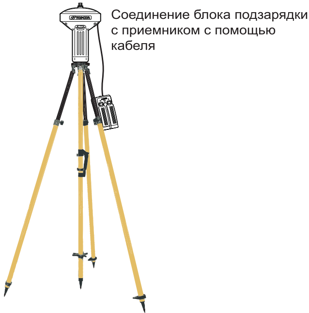
Рис. 2-15. Соединение блока подзарядки с приемником
