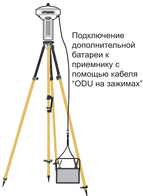
Рис. 2-16. Подключение дополнительной батареи к приемнику
