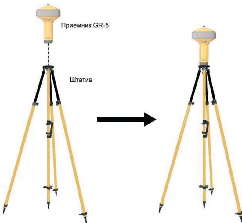
Рис. 4-1. Установка штатива и приемника над исходным пунктом
