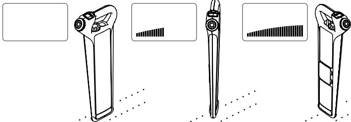
Отследите подземный кабель, держа С.А.T4 вертикально и размеренно перемещая его из стороны в сторону. Следуйте по маршруту пролегания кабеля, отмечая его, как требуется, по всей зоне земляных работ.
