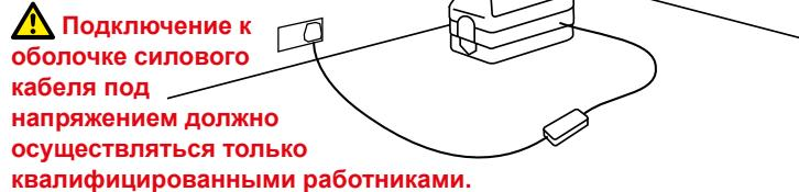
Штепсельный соединитель для кабелей под напряжением передает сигнал Genny на домашнюю электрическую розетку и, через систему проводки, на питающий кабель на улице.
