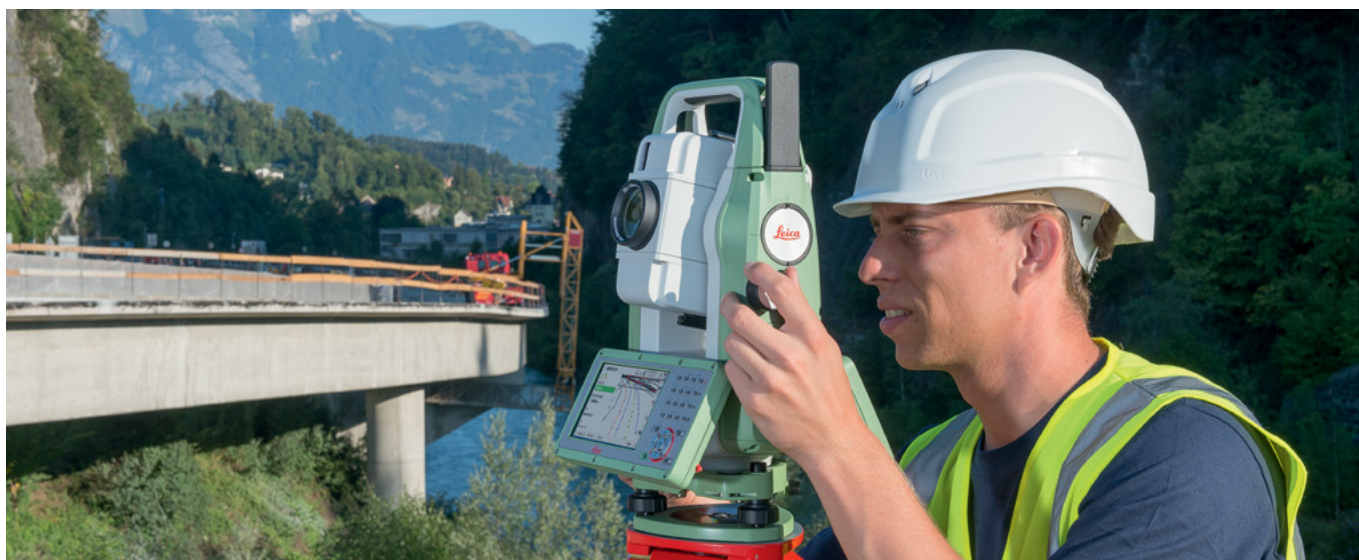
Рисунок 4 – 4G-модем обеспечивает высокоскоростное соединение с тахеометра с инструментом для моментального обмена данными с офисом.
