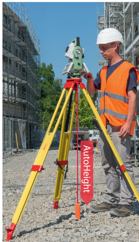
Рисунок 3 – измеряйте высоту установки инструмента с помощью нажатия всего одной кнопки на клавиатуре инструмента.
