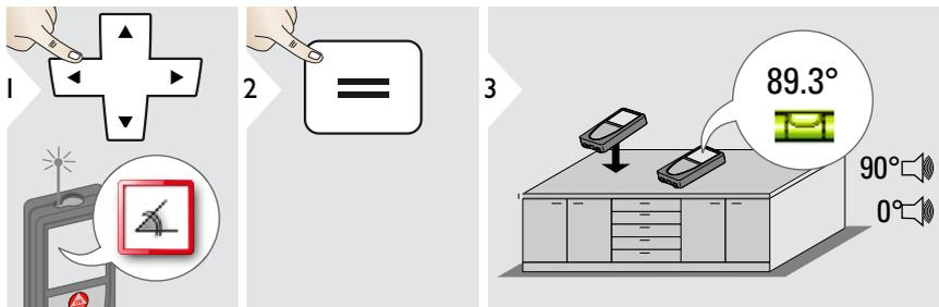
**i** Отклонение отображается постоянно. Прибор подает сигнал при углах  $0^\circ$  и  $90^\circ$ . Идеально подходит для регулировки горизонтали или вертикали.
