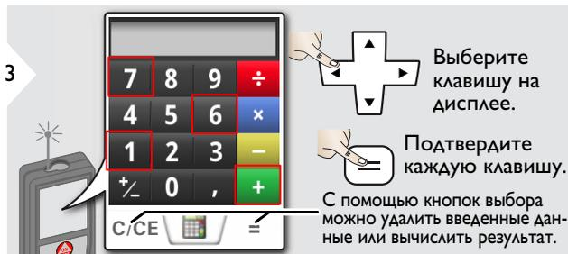
**i** Результат измерения переносится из главной строки в калькулятор и может быть использован для последующих вычислений. Дробь фут/дюйм переводятся в десятичную дробь фут/дюйм.
