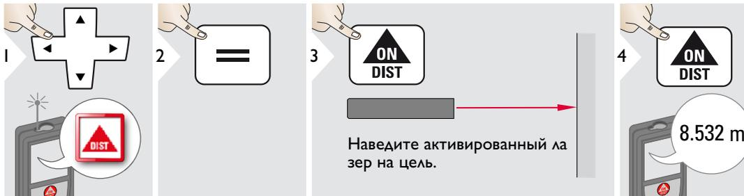
**i** Целевые поверхности: Ошибки при измерениях могут возникнуть в случае выполнения измерений до таких поверхностей, как бесцветные жидкости, стекло, стиролом, матовые полупрозрачные поверхности или при наведении на очень блестящие поверхности. При наведении на темные поверхности время измерения увеличивается.
