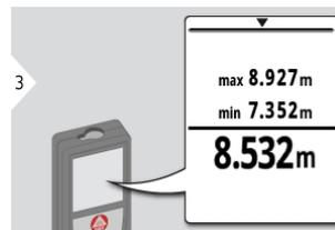
Измеренное минимальное и максимальное расстояние отображается на дисплее (мин, макс). Последнее измеренное расстояние отображается в итоговой строке.
