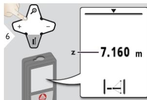
**i** Можно определить высоту здания или дерева без подходящих точек отражения. В нижней точке, измеряется расстояние и угол наклона - это требует отражающую лазерную мишень. Верхнюю точку можно отметить при помощи визира / окулярной сетки. Отражающая лазерная мишень не требуется, так как измеряется только угол наклона.
