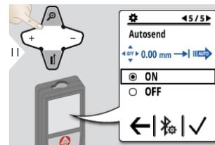
11 Выберите автоматическую или ручную передачу значения.
