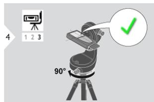
Поверните прибор по направлению движения часовой стрелки на 90°. Следуйте инструкциям на дисплее. Выравнивание завершено после появления иконки «OK» на дисплее.
