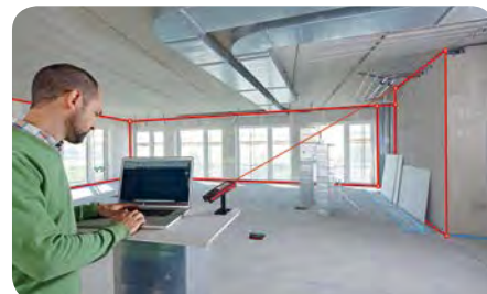
Передача координат точек в реальном времени
