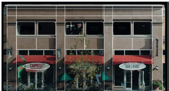
Некоторые из команд CloudWorx упрощают общий процесс трассировки облака точек, создавая корректные по размеру 2D или 3D каркасные сетки для реконструкции зданий, выдавливания моделей и т.д.
